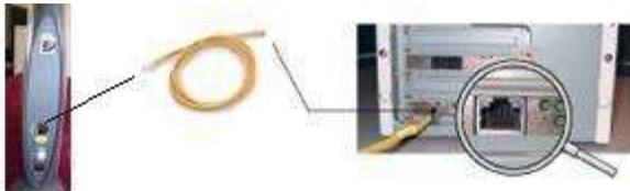
1. Conecta un extremo del cable amarillo **Ethernet** al en la entrada amarilla del **Módem**
