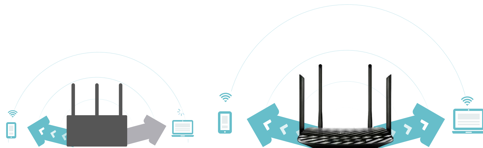
Router Tradicional Envía datos a un dispositivo a la vez
