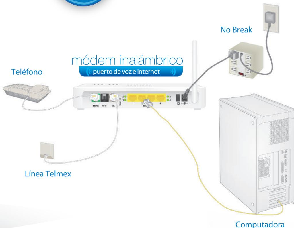
Te sugerimos conectar el módem a un No Break (no incluido en el kit), ya que la línea no cuenta con respaldo de energía.
