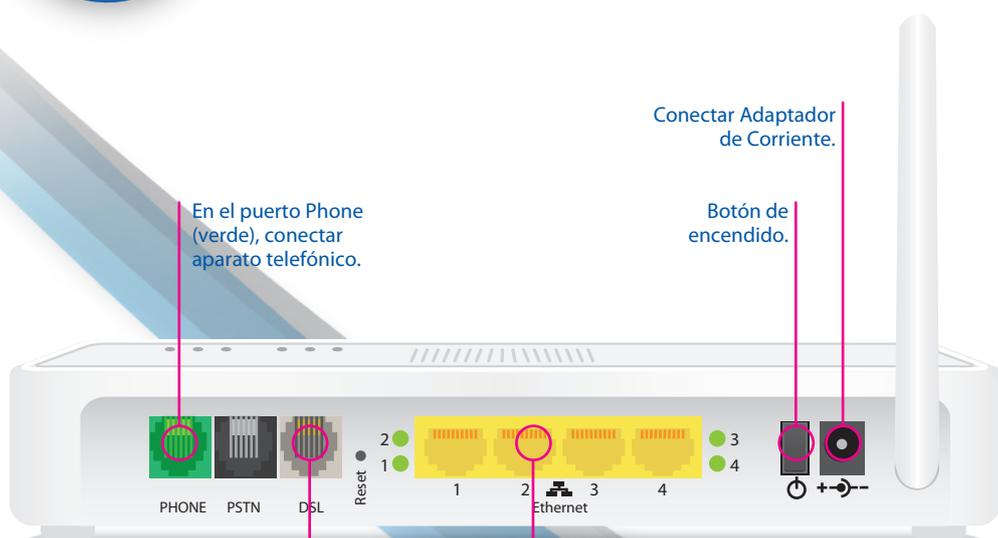
En el puerto DSL (gris) conectar cable y conector, hacia la roseta telefónica.
